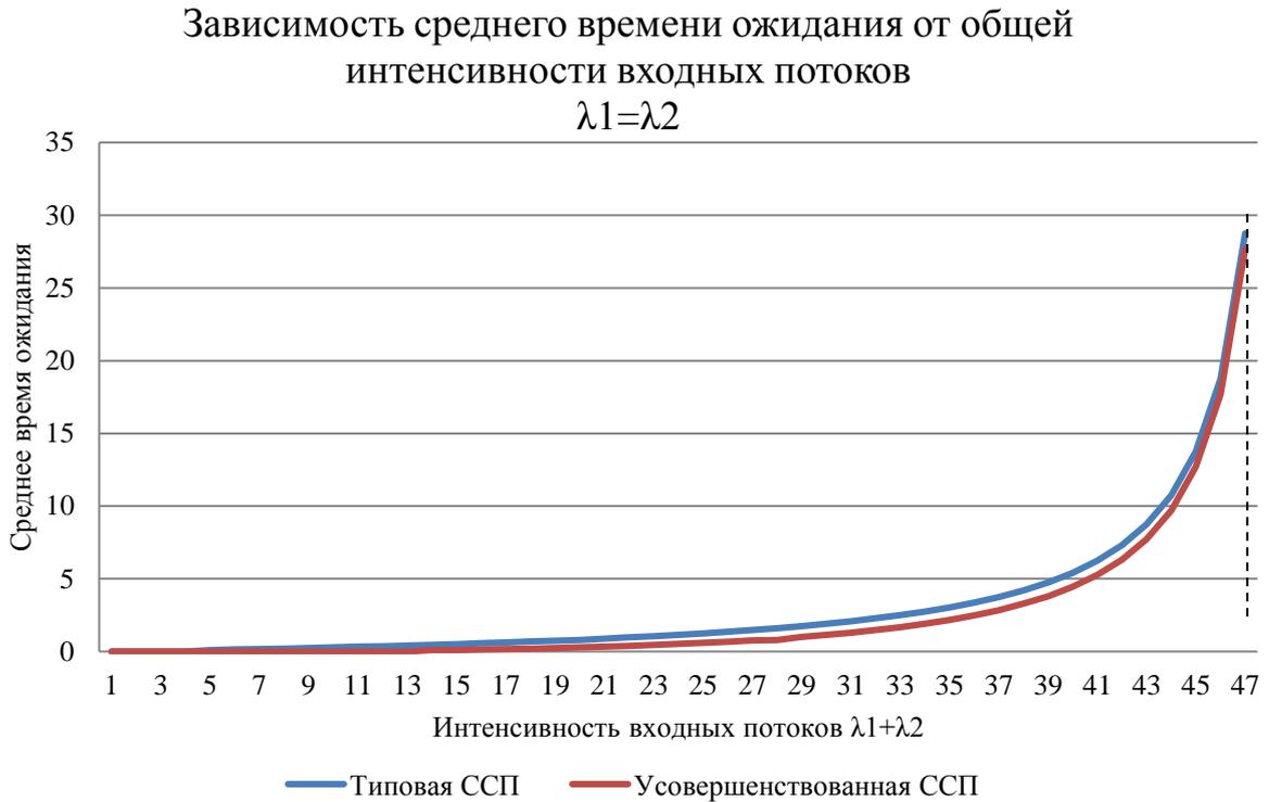
Рисунок 3.3 – График зависимости среднего времени ожидания от интенсивности потоков  $\lambda_1$  и  $\lambda_2$  в сети массового обслуживания типовой ССП и усовершенствованной ССП, при равномерном распределении потоков прибывающих ВС
