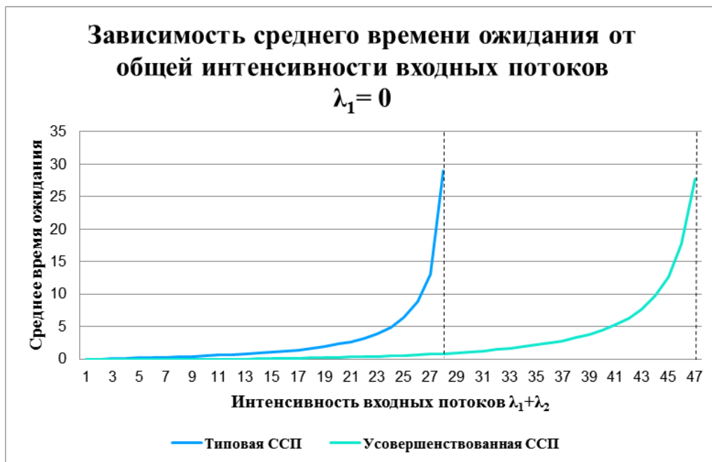
Рисунок 6 – График зависимости среднего времени ожидания T_{\text{оч}} ВС от суммарной интенсивности потоков \lambda = \lambda_1 + \lambda_2 в типовой ССП и усовершенствованной ССП при предельно неравномерном ( \lambda_1 = 0 ) распределении потоков прибывающих ВС
