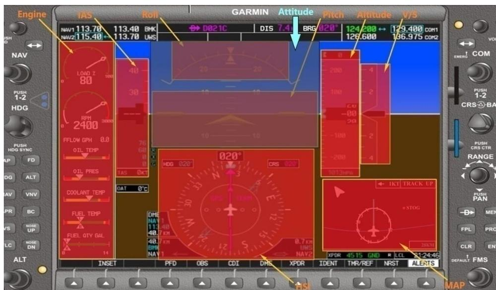
Рисунок 3.3 – Выделенные области индикации на PFD самолета DA 40 NG
