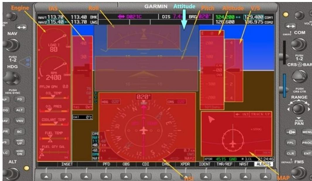
Рисунок 2.2 – Выделенные области индикации на PFD самолета DA 40 NG
