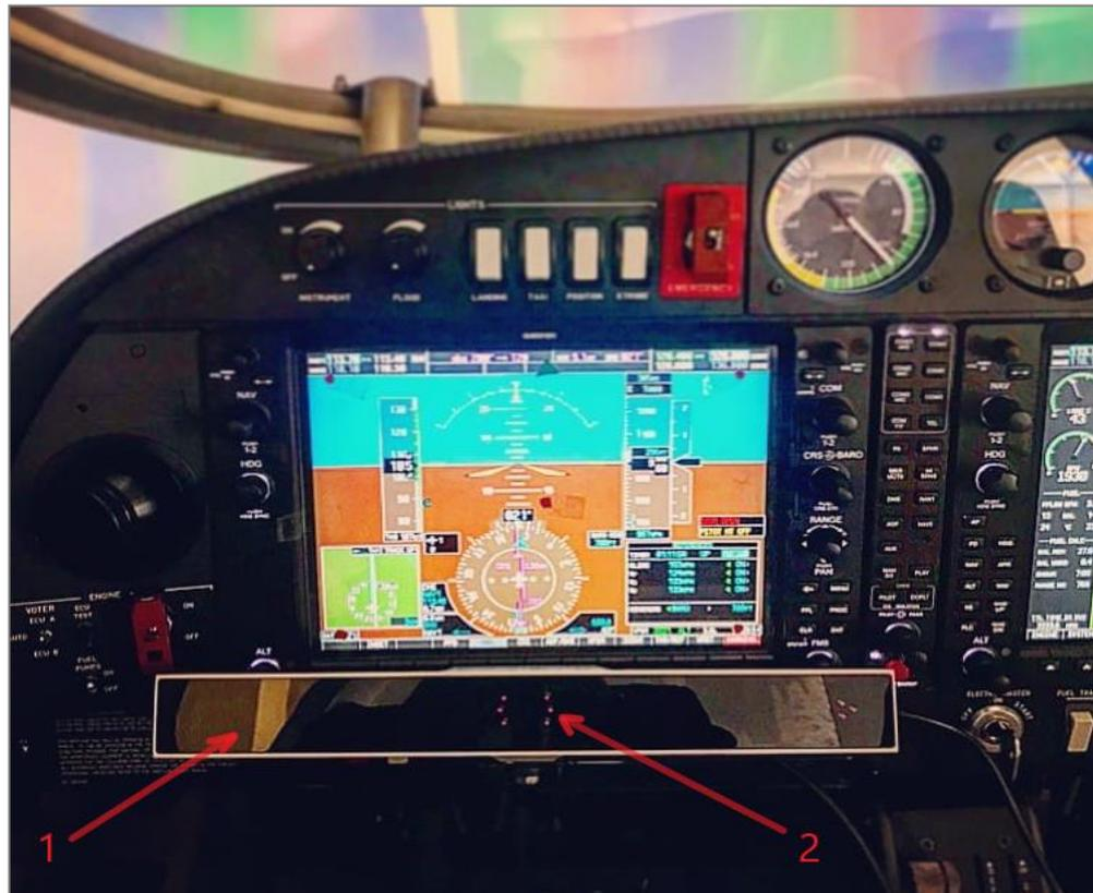
Рисунок 3.2 – Расположение ай-трекера Gazerpoint 3HD на приборной панели кабины пилота: 1 – ай-трекер Gazerpoint 3HD; 2 – инфракрасные датчики
