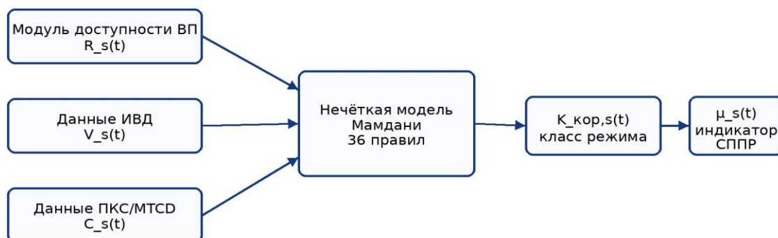
Рисунок 2 – Информационный контур расчёта динамической корректировки пропускной способности сектора ОВД
