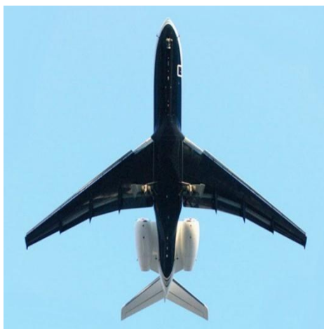
Рис. 7 – Правило площадей, примененное в хвостовой части самолета Bombardier Global Express
