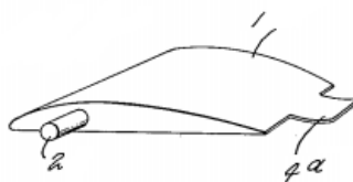
Рис. 13 – Свободновращающийся турбулизатор. 1 – турбулизатор, 2 – ось вращения, 3 – поверхность крыла, 4а – триммер [76]
