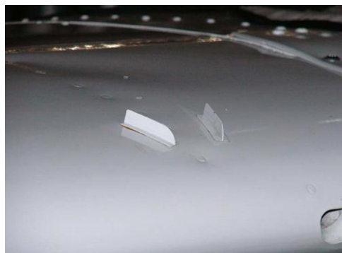
Рис. 10 – Турбулизаторы на крыле самолета Cessna-172
