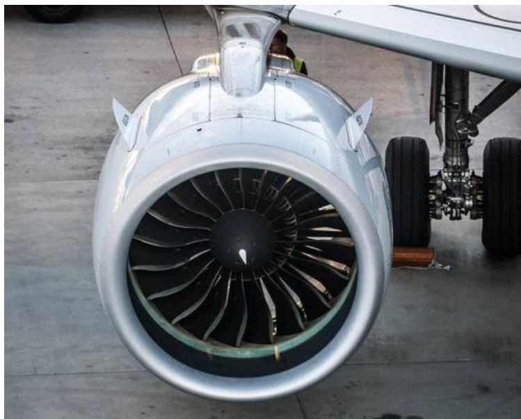
Рис. 21 – Гондола двигателя Pratt & Whitney 1000G на самолете A320NEO с двумя аэродинамическими гребнями.
