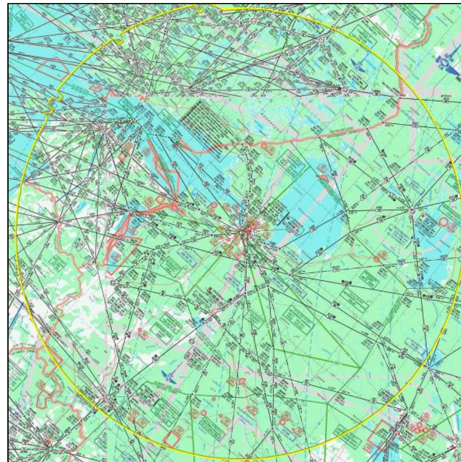
Рисунок 4.14 – Зона покрытия вторичного канала радиолокаторов в Санкт-Петербургском центре ОВД для высоты полета 10000м
