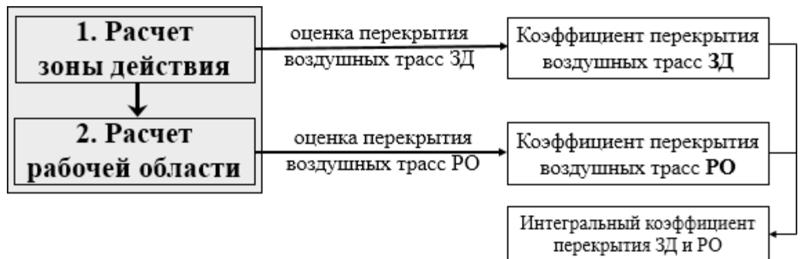
Рисунок 2.28 – Алгоритм двухэтапного анализа ЭХ средств РТОП
