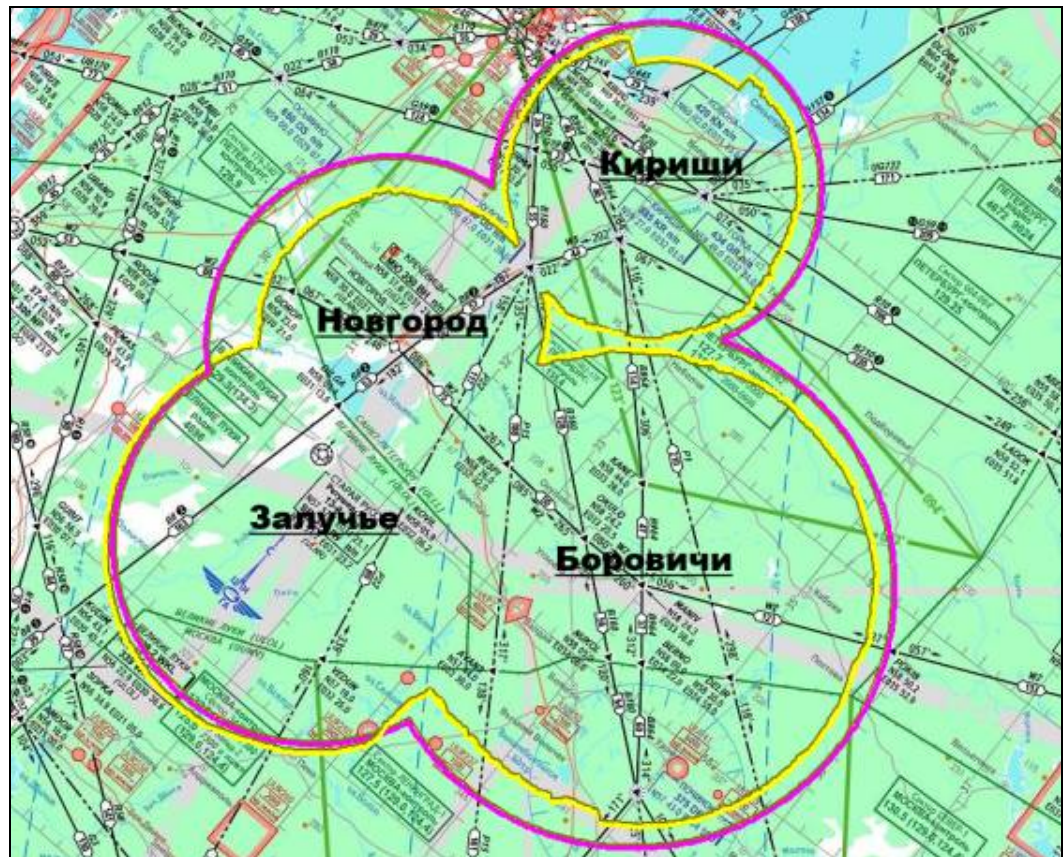
Рисунок 2.19 – Зоны действия АРТР Боровичи, Кириши, Новгород и Залучье для высоты полета 200м, рассчитанные с учетом углов закрытия
