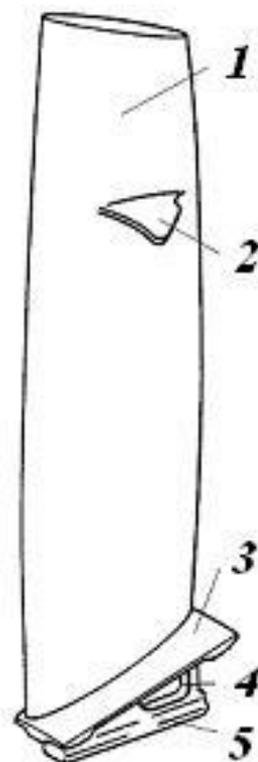
Рис. 2.30. Лопатка вентилятора: 1 – перо; 2 – полка; 3 – платформа; 4 – ножка; 5 – хвостовик
