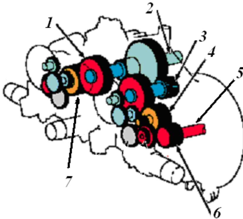
*Рис. 4.18. Редуктор: 1 – ведомая шестерня 2-ой ступени; 2 – выходной вал; 3 – ведущая шестерня 3-ей ступени; 4, 7 – ведомые шестерни 1-ой ступени; 5 – входной вал; 6 – ведущая шестерня 1-ой ступени*
