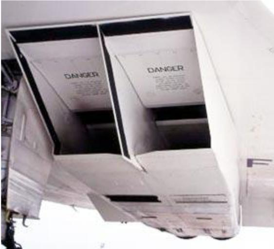
*Рис. 1.07. Сверхзвуковой воздухозаборник самолета Concorde*
