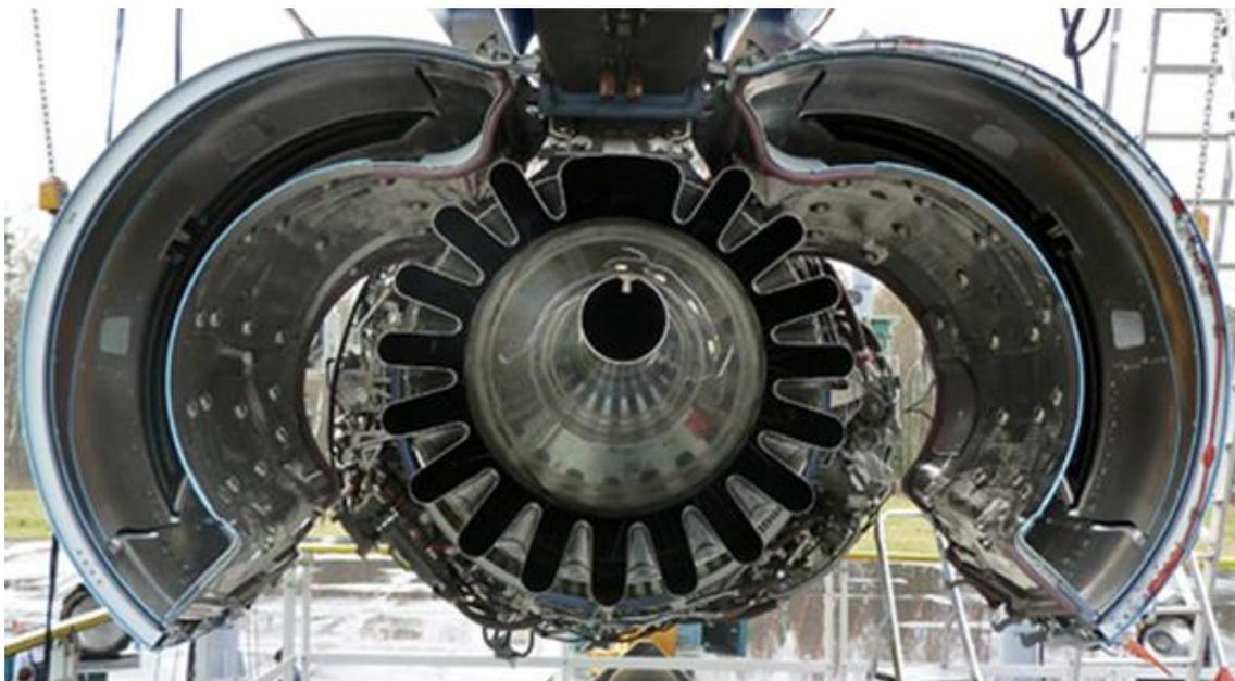
*Рис. 2.47. Вид на двигатель сзади (створки мотогондолы открыты)*
