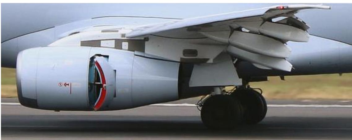
*Рис. 2.46. Крыло с мотогондолой двигателя (реверс в открытом положении)*
