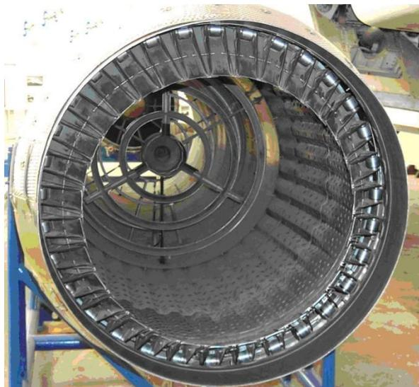
*Рис. 1.09. Форсажная камера, удлинительная труба и первичное сопло*
