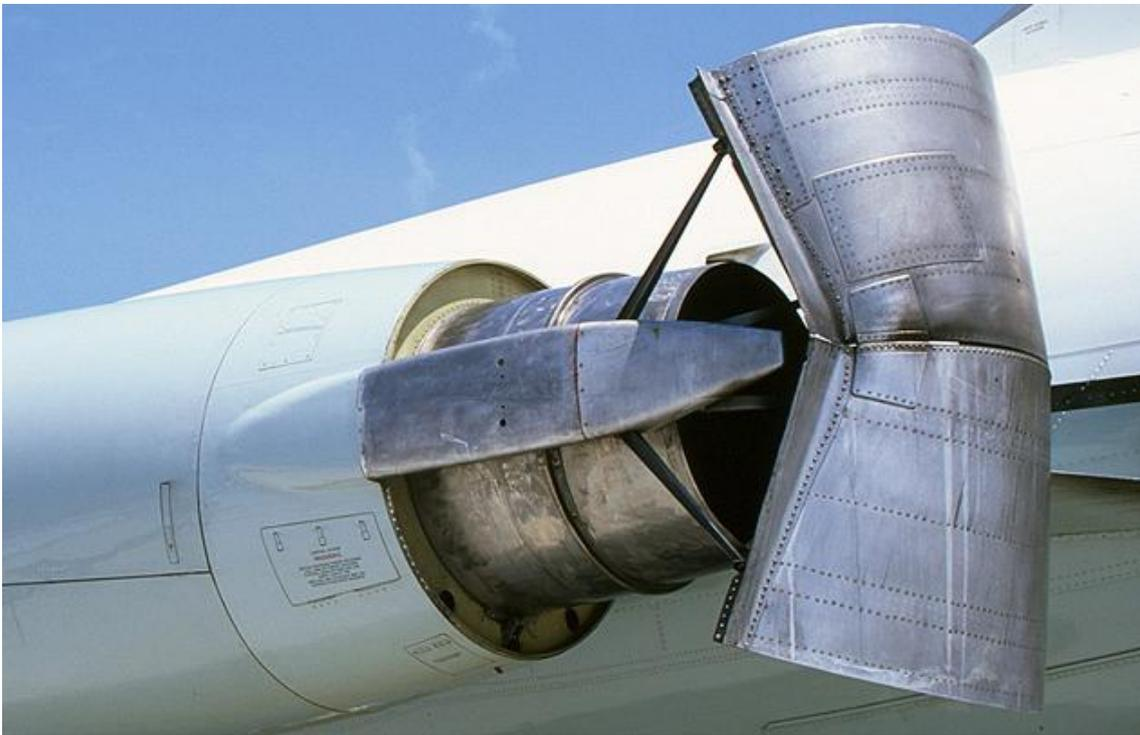
*Рис. 2.15. Реверсивное устройство на самолете McDonnell Douglas DC-9*
