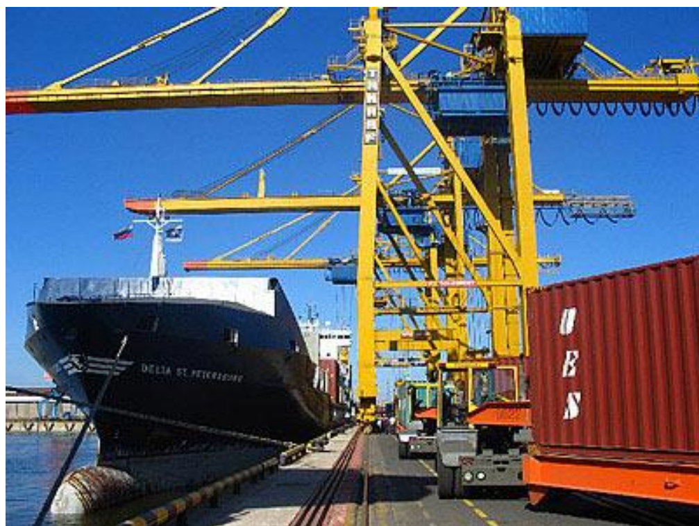
Рис.16. Механизация морского контейнерного терминала 1.Перегрузка контейнеров с морского судна мостовым перегружателем 2.Перегрузка контейнеров козловым контейнерным краном
