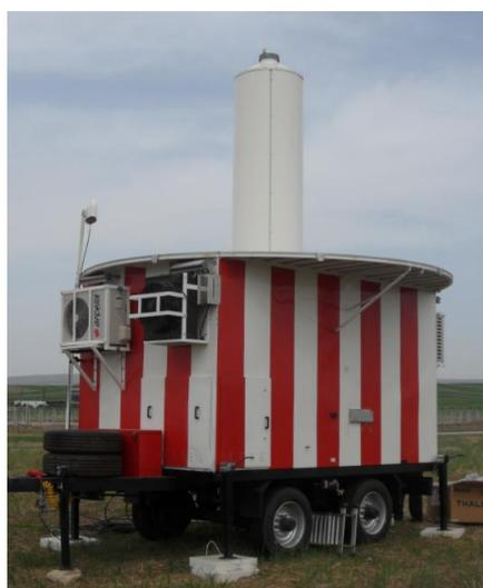
Рисунок 2.9 – Мобильный вариант VOR фирмы Thales
