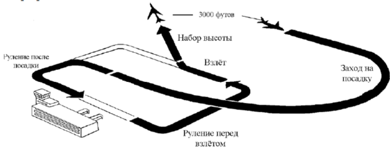
Рис. 1 – Стандартный взлётно-посадочный цикл ИКАО
